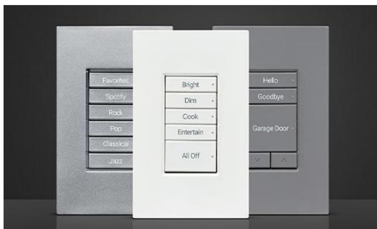
Dimmer + teclado 2 a 7 teclas configuráveis Contemporary com várias combinações, comunicação sem fios com Controladores Control4, 2 Leds com cores personalizáveis e sensor de luminosidade. Funciona como dimmer isolado ou dimeriza através de comandos de outros componentes Control4. Potência 600W e Comunicação ZigBee
